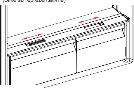
U slučaju da je odeljak za voće i povrće u potpunosti pun, potrebno je otvoriti otvor za svežinu koji se nalazi sa prednje strane odeljka za voće i povrće. To omogućava kontrolu vazduha i stope vlažnosti u odeljku za voće i povrće, čime se produžava trajanje hrane.
