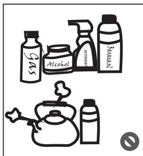
Nije dozvoljena uporaba oštih ili metalnih predmeta kako bi se otklonio led s površina, jer se tako mogu oštetiti dijelovi sistema za hlađenje i unutrašnjost. Nije dozvoljena uporaba grubih četki, metalne vune, abrazivnih sredstava, organskih otapala (alkohol, acetona, benzin, itd.), vruće vode, kiselina ili lužina. Aparat se ne smije čistiti visokotlačnim parnim aparatom za čišćenje jer može doći do kratkog spoja i oštećenja, kao ni prskanjem vodom.
