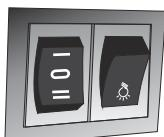
Za pokretanje uređaja u prvoj brzini pomaknite sklopku brzine u gornji položaj (Slika 18).
