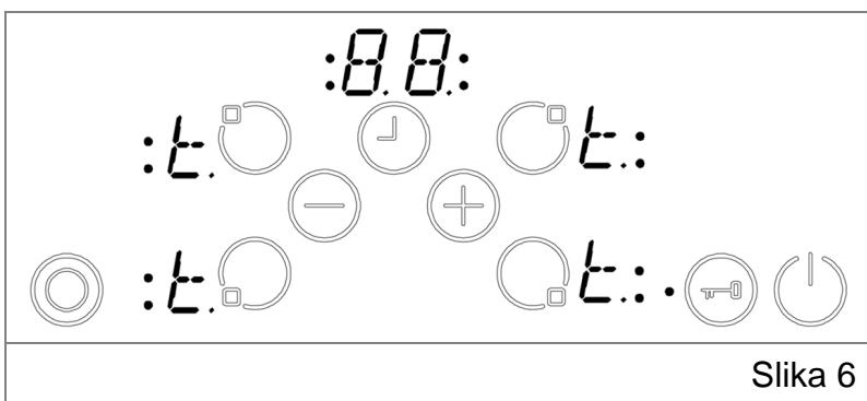
Kada temperatura rada kuhala padne na manju vrijednost, slovo "t" se isključuje, a samo kuhalo prelazi u mod mirovanja ("S" način rada). Kuhalo možete ponovno uključiti pritiskom na
