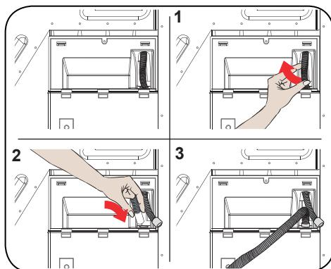
**! PAŽNJA:** Crijevo je potrebno postaviti tako da ne može ispasti. Ako se crijevo odspoji tijekom odvoda vode, može nastati poplava.
